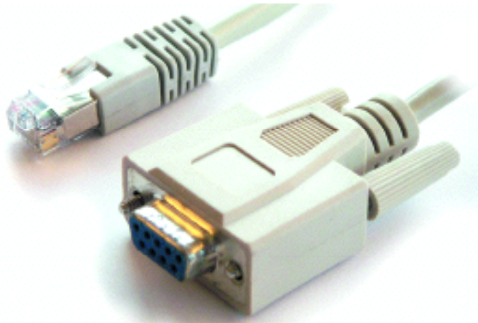
De gauche à droite connecteurs RJ45 et RS232
