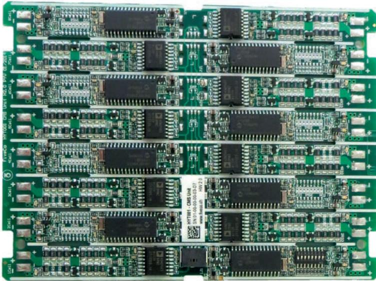
*Gestionnaire de batterie permettant le contrôle de la charge de chaque cellule indépendamment. Il a été mis à l'essai sur la ZEOD, un véhicule hybride du constructeur automobile NISSAN pour les 24 heures du Mans.*
