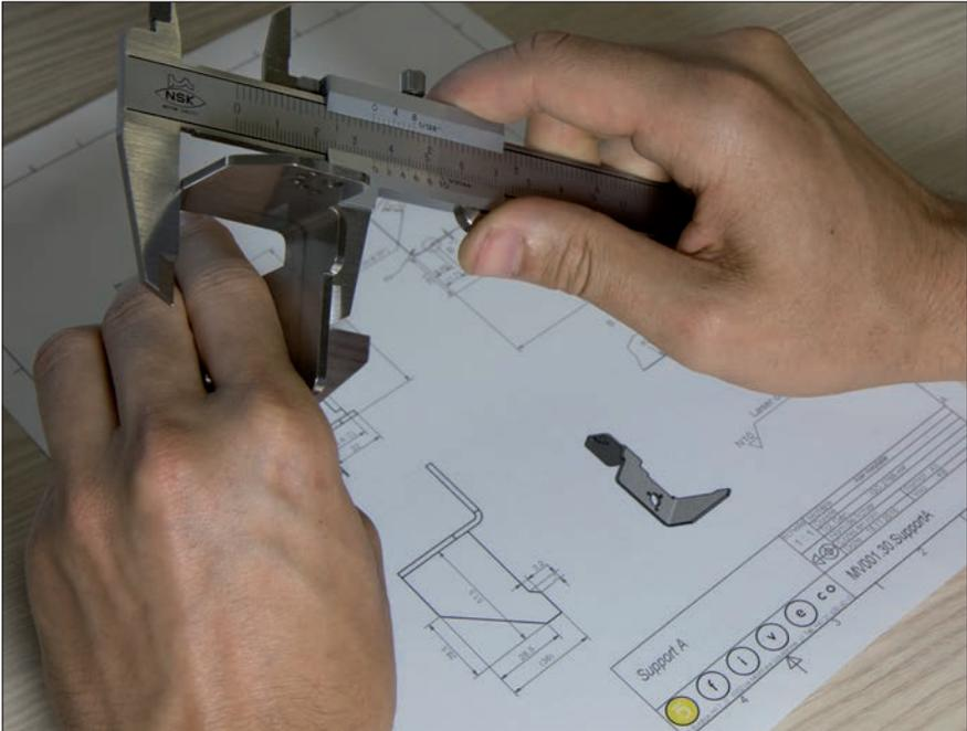
*Vérification d'une pièce d'après les plans de fabrication.*
